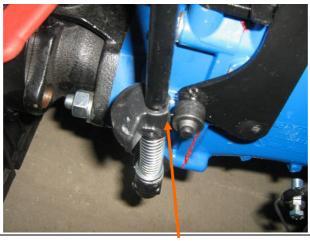
PTO LEVER **FULLY ENGAGED**. NOTE: THERE IS ONLY ABOUT 1/8" (OR LESS) SPACE BETWEEN PLASTIC KNOB ON PTO LEVER AND ROLLER ON REVERSE LINKAGE. **USE THE CLUTCH WHENEVER SHIFTING THE PTO OR WHEEL SPEED / DIRECTION!!!!!!!**
