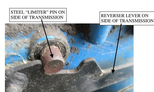
THE ABOVE PICTURE SHOWS THE REVERSER LEVER IN THE "FORWARD" POSITION FOR TILLING (OR "REVERSE" POSITION FOR MOWING). IN THIS POSITION, THE **SPRING** IS PULLING THE LEVER AGAINST ONE SIDE OF THE LIMITER PIN.
